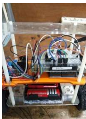
Gambar 14. Hasil Perakitan Sistem Elektrik Robot Self Balancing
