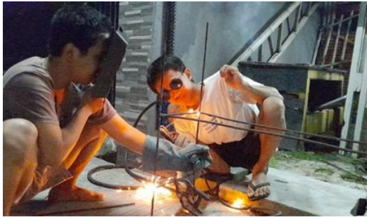
Gambar 3. Pengelasan Rak Sepatu dan Penyelesaian Tahap Akhir
