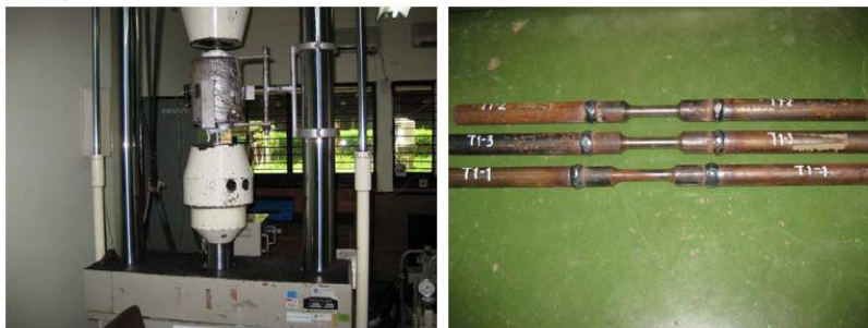
Gambar 2.2 Mesin uji tarik dan benda uji tarik temperatur tinggi
