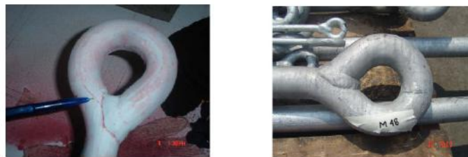
Gambar 1.2 Hanger Rod retak setelah pembentukan (kiri), ukuran penampang tidak seragam (kanan)
