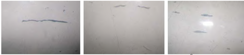
Gambar 3.7 Hasil foto mikroskop pada sampel hasil pembentukan temperatur 600 °C (kiri), temperatur 700 °C (tengah), temperatur 800 °C (kanan), perbesaran 500X.
