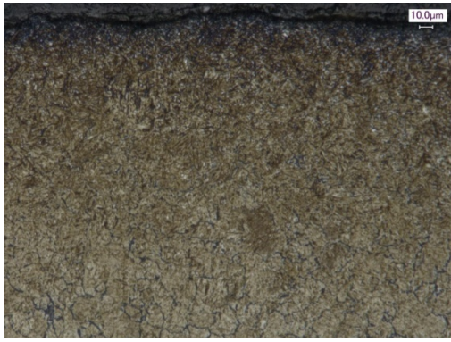
Foto Struktur Mikro Temperatur 850° Pada Holding Time 120 Menit Bagian Luar Pembesaran 400x
