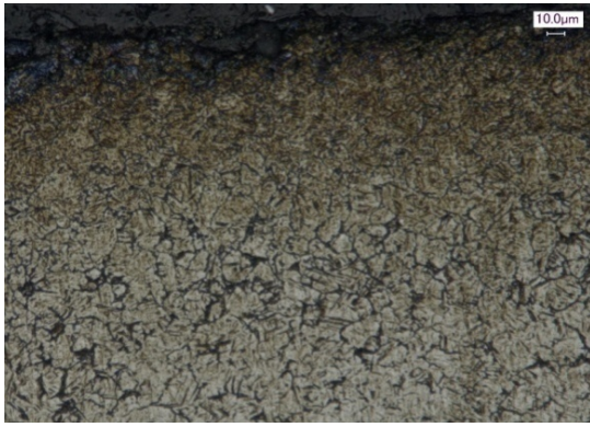
Foto Struktur Mikro Temperatur 850° Pada Holding Time 60 Menit Bagian Luar Pembesaran 400x
