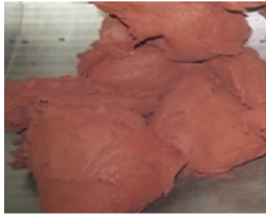
Gambar 5. Hasil Compound 3 dengan waktu pencampuran 6,2 menit
